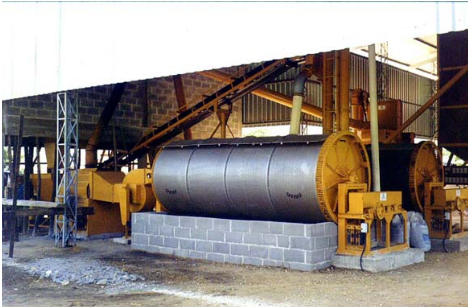
Café Natural, secagem em secador de fogo indireto
